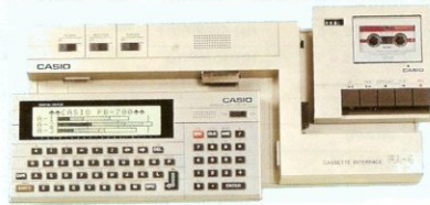
FA-4 * Abmessungen (H x B x T) ca. 44,5 x 315 x 130 mm, Gewicht 676 Gramm.
